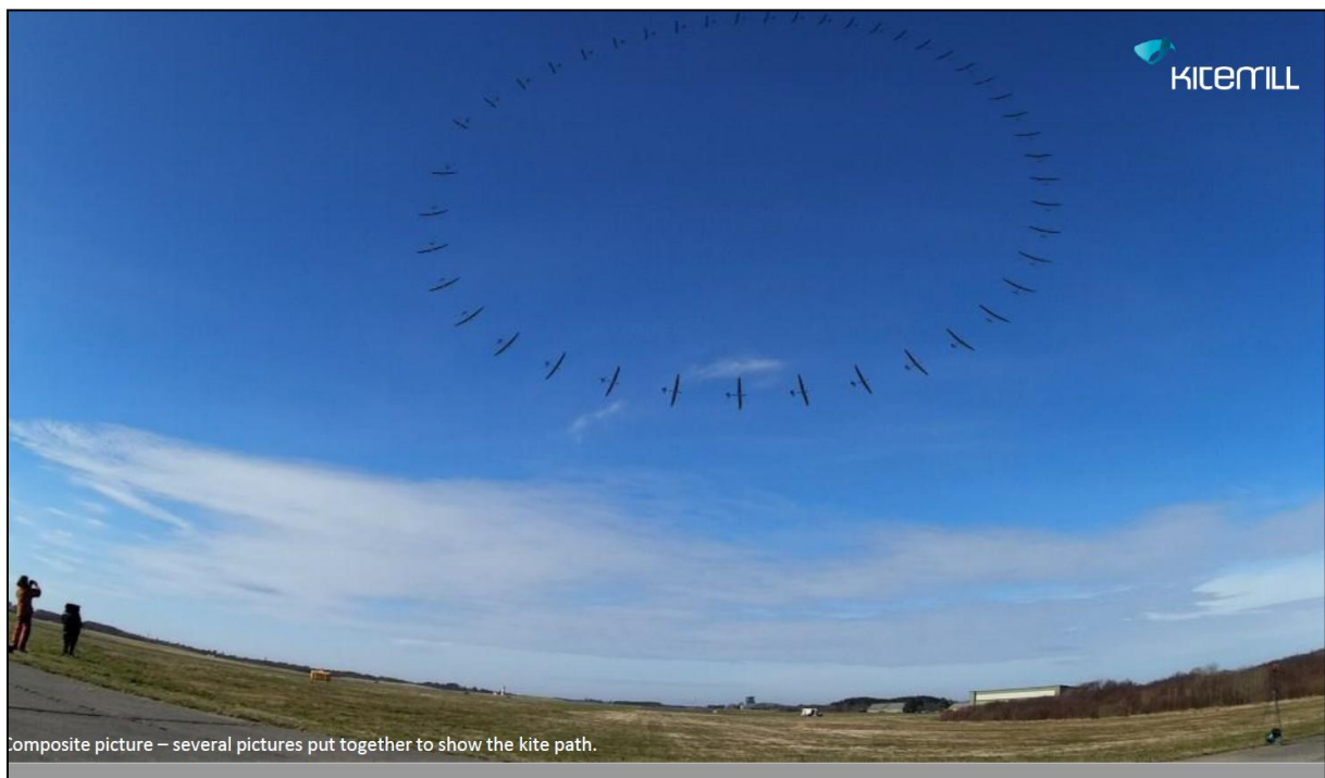
Fig. 4. Ved kjøring/produksjon i anlegget kjører kiten i spiral (se Fig. 3), eller for den enkelte spiral i en sirkel. Kilde: Kitemill AS.
